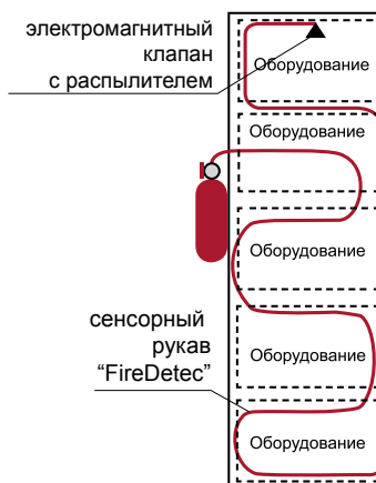
монтаж установки АУП-01Ф-02-1
