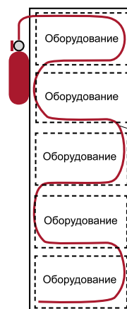
монтаж установки АУП-01Ф-01-1
